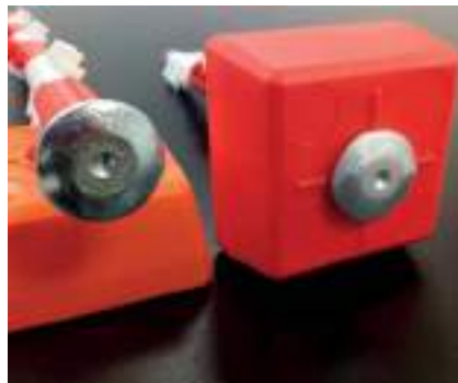
Testa con svasatura per la materializzazione del punto a terra
